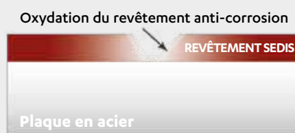
TENUE DU TRAITEMENT ANTICORROSION EN BROUILLARD SALIN SUIVANT ASTM B117
