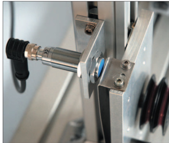
Analoger Sensor für die Anpassung der Spulendrehzahl / Analogue sensor for spool speed adjustment
